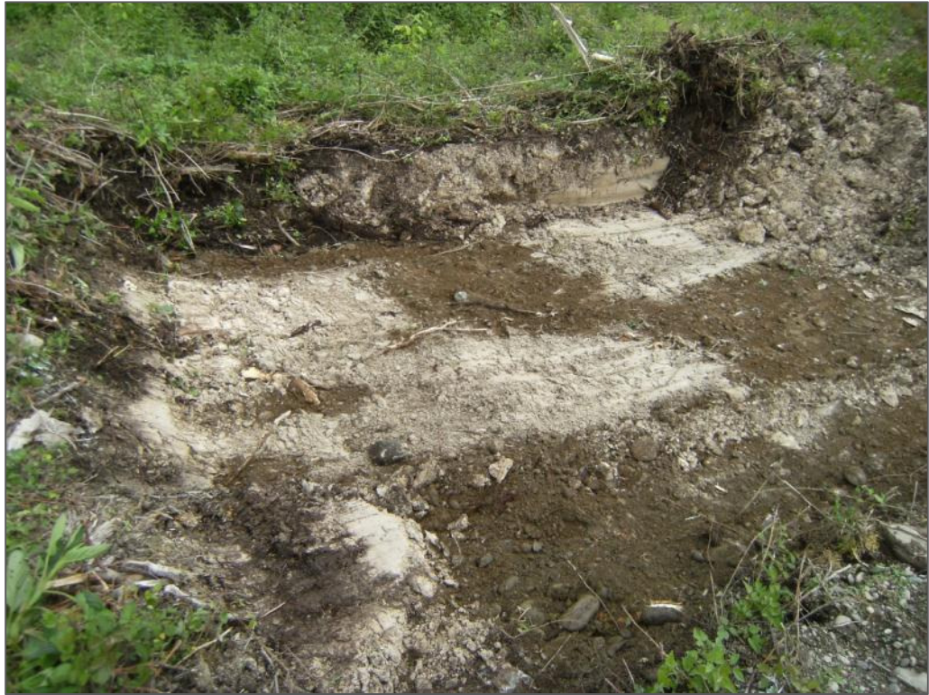
Photographie 6-1: Parcelle 9 : distinction entre sol et boues de zinc blanchâtres lors des excavations
